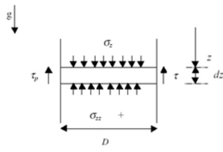
Figura 3. Tensiones en un elemento cilíndrico
