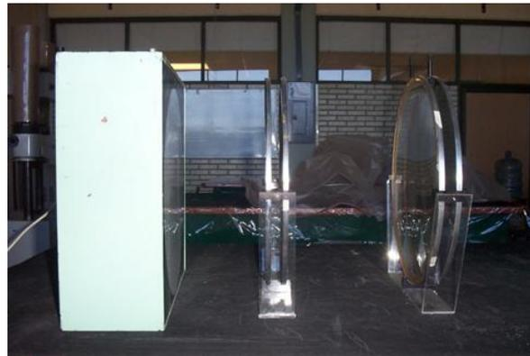
117 **Figura 3. Polariscopio utilizado en el laboratorio de metrología de UPIITA.**
