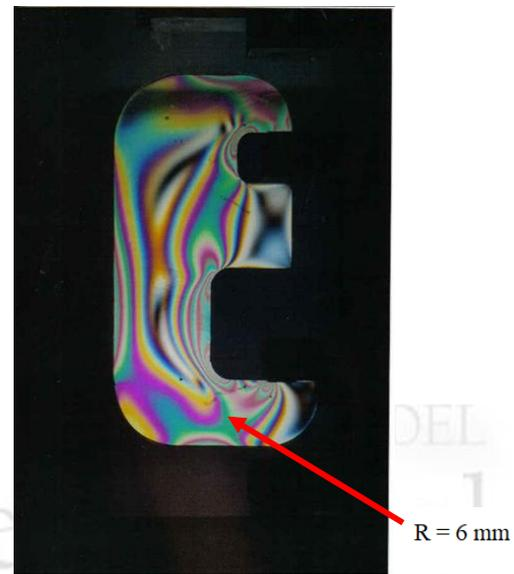
Figura 8. Bastidor de prensa tipo “C” con un radio de 6 mm, presenta 7 franjas y un máximo esfuerzo normal de 8.18 MPa con una carga de 100N.
