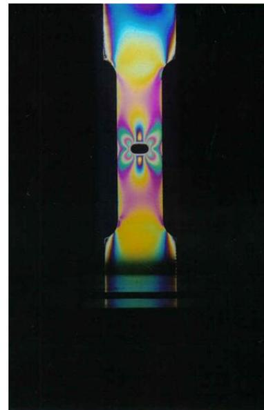
Figura 6. Elemento a tensión con barreno elíptico perpendicular a la aplicación de una carga de 98.1N, presenta 3 franjas y un máximo esfuerzo normal de 3.8 MPa.
