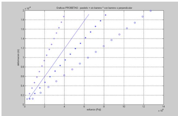
Figura 13. Gráfica de probetas a tensión
