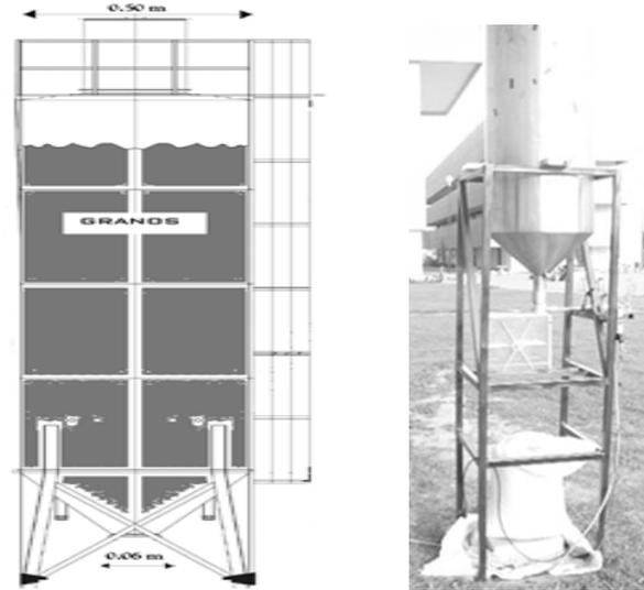
Figura 15. Medidas del silo tomando en cuenta la relación de diámetros y prototipo final.
