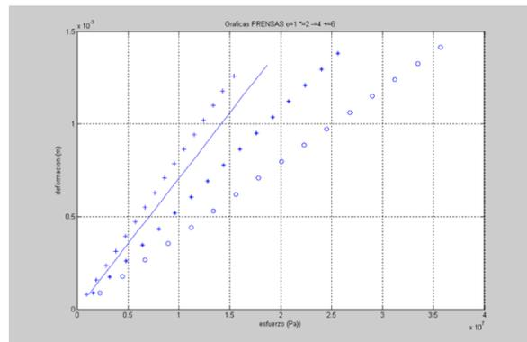
Figura 14. Gráfica de bastidores de prensa tipo “C”.
