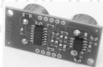
187 **Figura 8. Sensor de altura ultrasónico SRF05**
