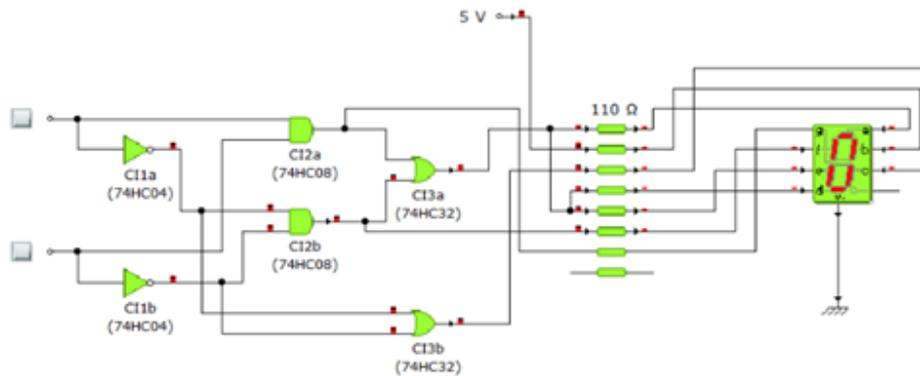
**Figura 4.** Diseño de compuertas lógicas digitales de la función simplificada
