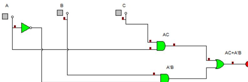
206 **Figura 3.** Diseño de compuertas lógicas digitales de la función simplificada
