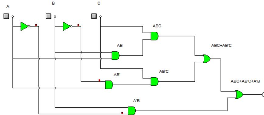
195 **Figura 2.** Diseño de compuertas lógicas digitales de la función inicial
