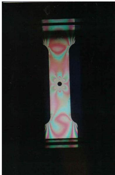
Figura 5. Elemento a tensión con barreno circular al centro, presenta 5 franjas y un máximo esfuerzo normal de 5.84 MPa con una carga de 223 N.
