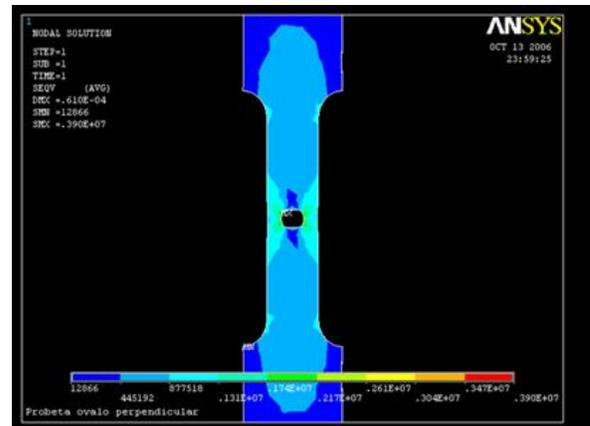
Figura 10. Elemento a tensión con barreno elíptico perpendicular a una carga de 98.1N, presenta un máximo esfuerzo normal de 3.9 MPa
