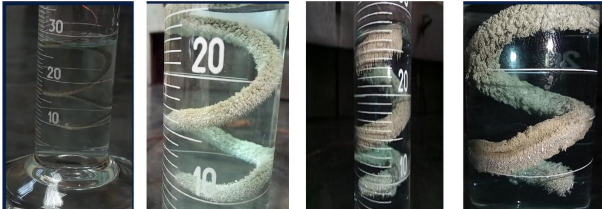
**Figura 7. Secuencia de producción experimental de fractales de Plata.**
