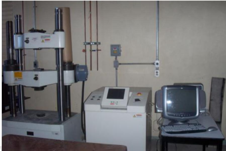
Figura 4. Prensa universal utilizada en el laboratorio de metrología de UPIITA.
