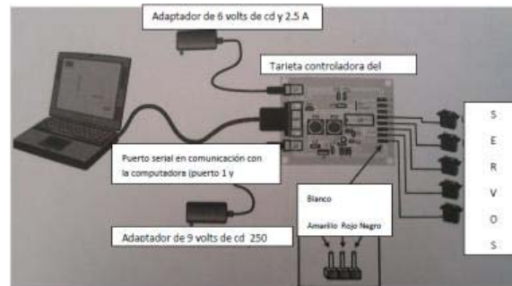
Figura 6. Descripción del dispositivo completo de control.
